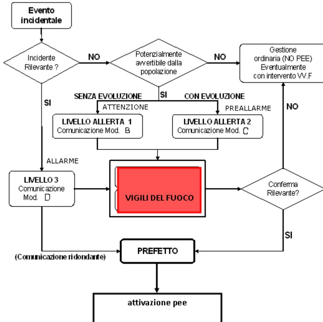
Figura 0-3: Schema logico di segnalazione di incidente e attivazione del PEE
