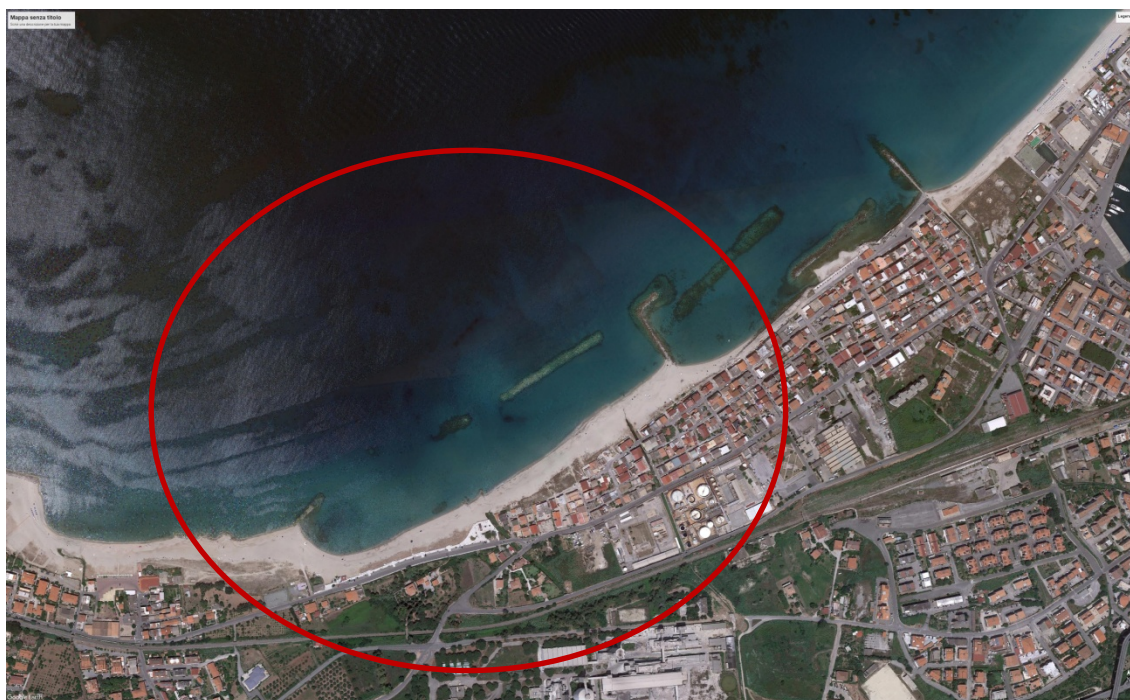
Figura 24 – Andamento del litorale al (30-06-2016) – Anche se nel periodo (03.07.2014) – (30.06.2016) non sono state realizzate opere nel tratto in oggetto si nota una stabilizzazione del litorale nel tratto in oggetto.
