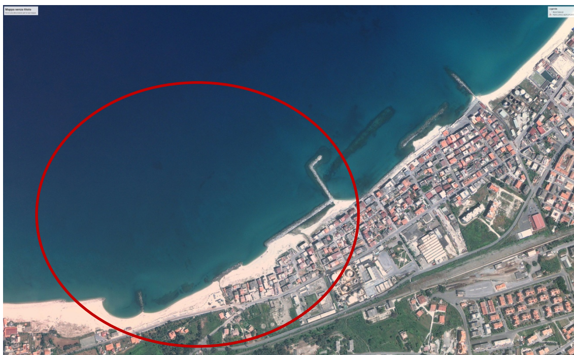
Figura 30 – Andamento del litorale dopo la realizzazione del pennello (§3.2) - (05-02-2010) Si nota che la realizzazione del pennello non ha apportato benefici sull'andamento della linea di riva
