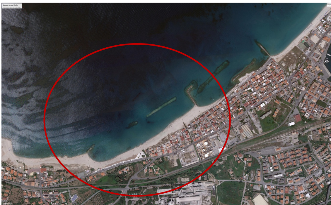
Figura 32 – Andamento del litorale al (30-06-2016) – Anche se nel periodo (03.07.2014) – (30.06.2016) non sono state realizzate opere nel tratto in oggetto si nota una stabilizzazione del litorale nel tratto in oggetto.
