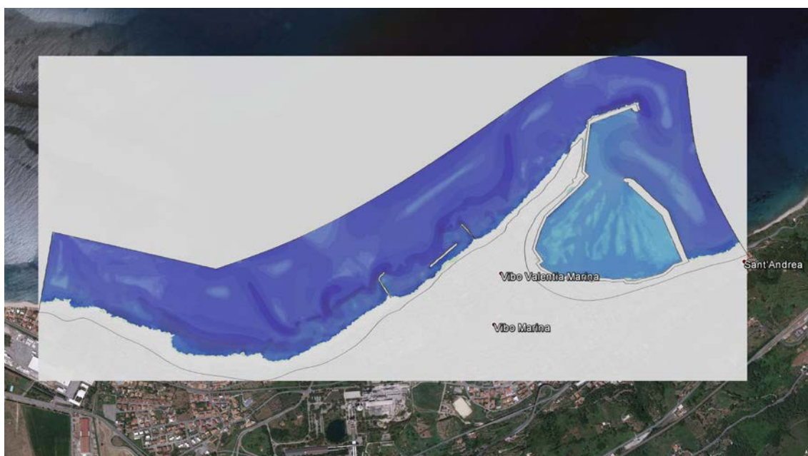
Figura 35 – Andamento del flusso della corrente – Configurazione di Progetto Definitivo
