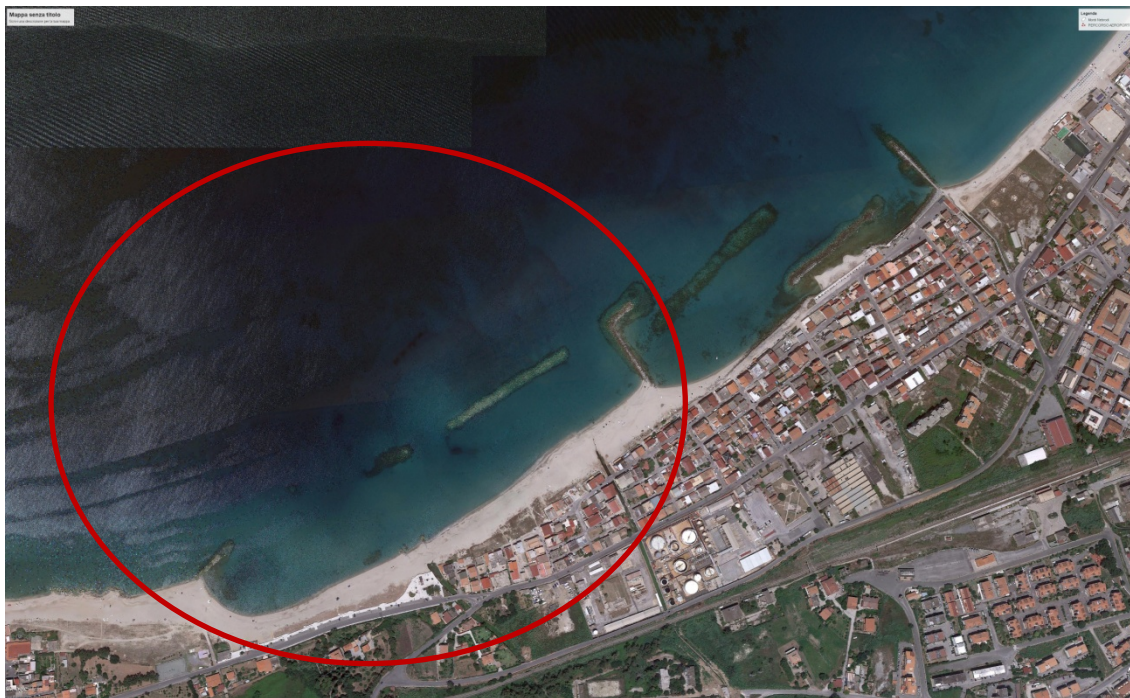
Figura 31 – Andamento del litorale dopo la realizzazione del pennello e della prima barriera (§3.3) - (03-07-2014)
