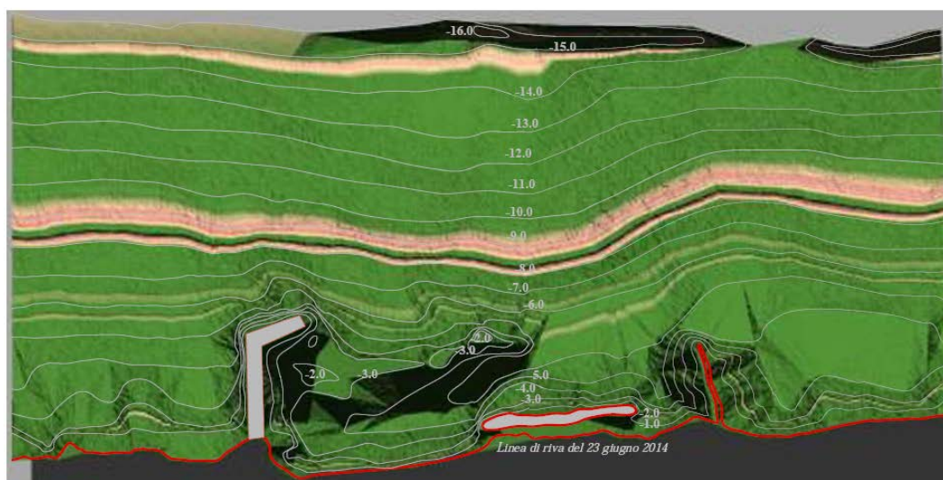
Figura 12 – Analisi del fondale mediante modellazione DTM Vibo Marina
