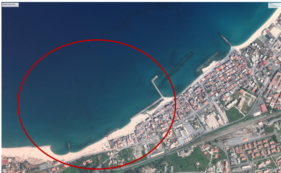
Figura 24 – Andamento del litorale dopo la realizzazione del pennello (§3.2) - (05-02-2010) Si nota che la realizzazione del pennello non ha apportato benefici sull'andamento della linea di riva
