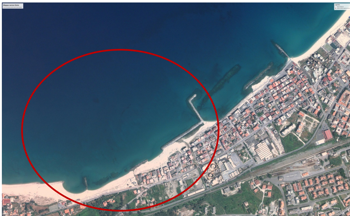
Figura 34 – Andamento del litorale dopo la realizzazione del pennello (§3.2) - (05-02-2010) Si nota che la realizzazione del pennello non ha apportato benefici sull'andamento della linea di riva
