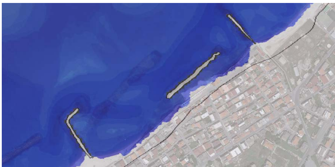
Figura 26 – Andamento del flusso della corrente – Stato di fatto - Vibo Marina – zona Capannina
