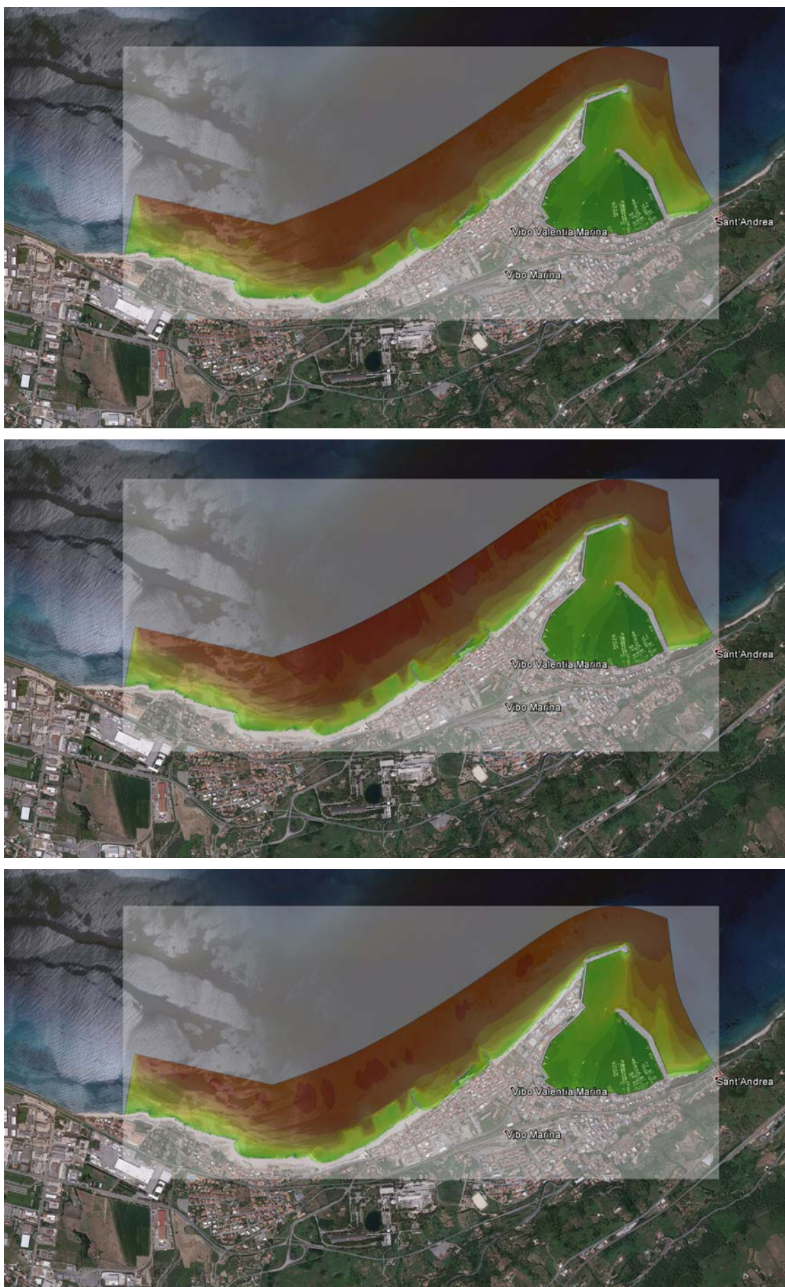
Figura 25 – Andamento dell'onda dai settori 24 – 1 - 2 – modello SW - Modello di dettaglio - Vibo Marina
