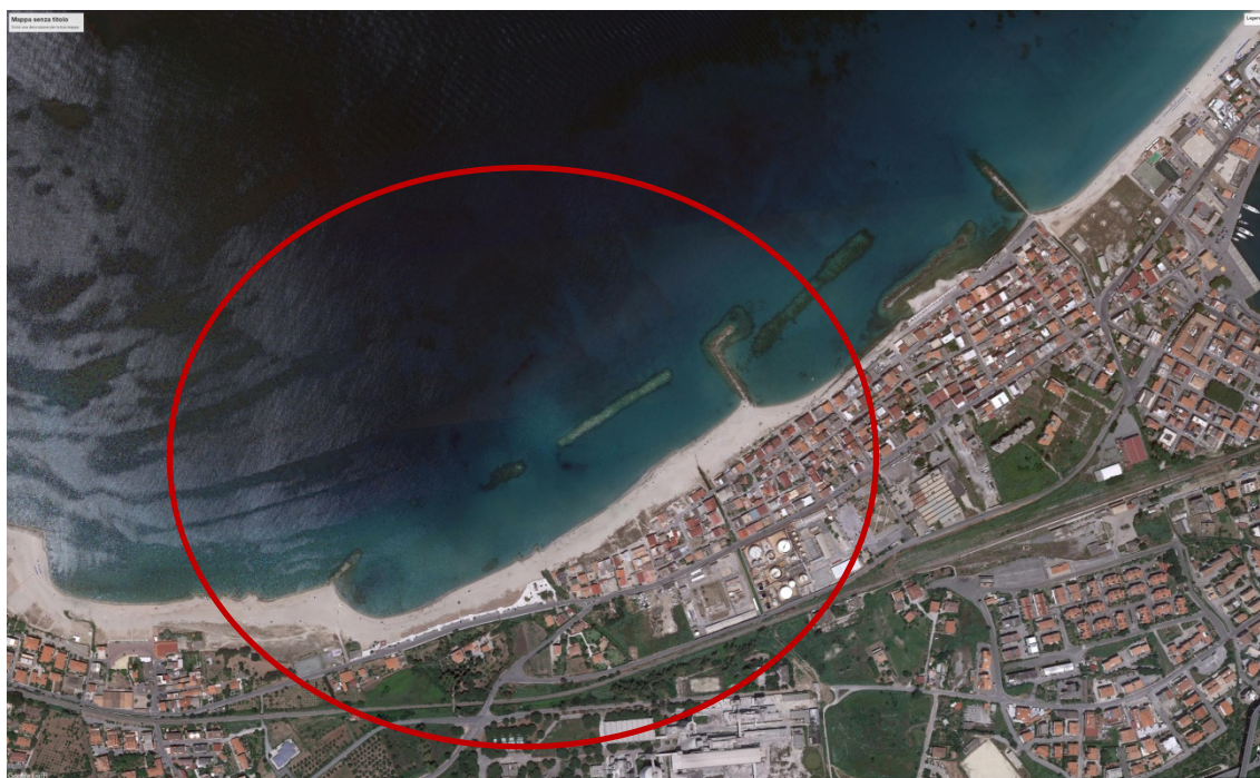
Figura 26 – Andamento del litorale al (30-06-2016) – Anche se nel periodo (03.07.2014) – (30.06.2016) non sono state realizzate opere nel tratto in oggetto si nota una stabilizzazione del litorale nel tratto in oggetto.
