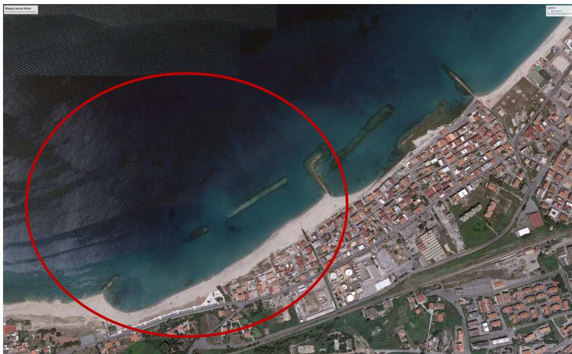
Figura 25 – Andamento del litorale dopo la realizzazione del pennello e della prima barriera (§3.3) - (03-07-2014)
