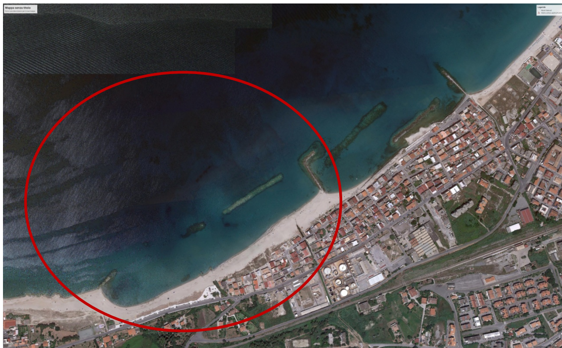
Figura 23 – Andamento del litorale dopo la realizzazione del pennello e della prima barriera (§3.3) - (03-07-2014)
