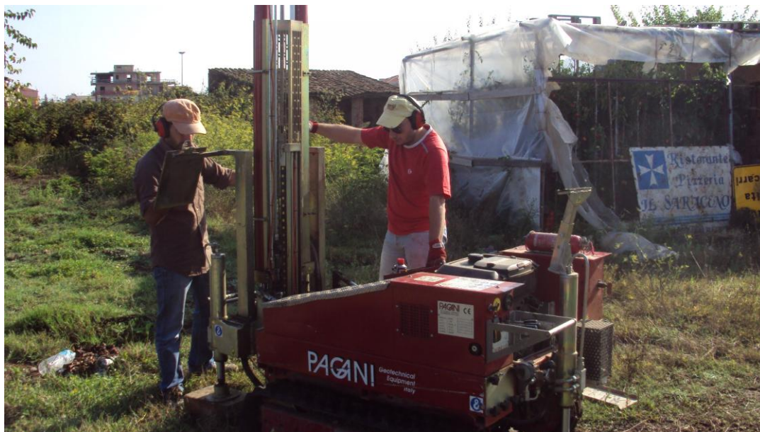
Foto 1: ubicazione prova penetrometrica dinamica n.1 Ditta ANAS S.p.A. – Comune di Vibo Valentia (VV)
