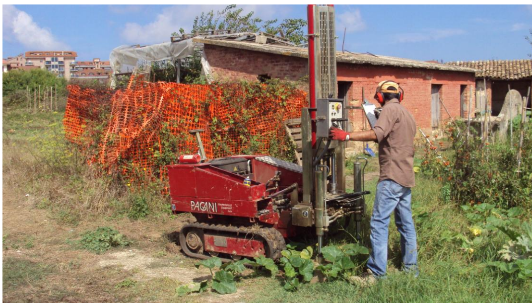
Foto 4: ubicazione prova penetrometrica dinamica n.4 Ditta ANAS S.p.A. – Comune di Vibo Valentia (VV)
